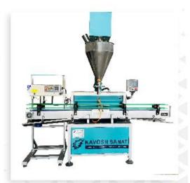
جهت بسته بندی انواع مواد پودری به صورت نیمه اتوماتیک در کیسه و یا قوطی می باشد. این دستگاه مجهز به سیستماوگر سیستمPLC، نمایشگرلمسی ۷ اینچی و کانوایر است. عملکرد توزین دستگاه پرکن قوطی و کیسه پودری سیستماوگر یامارییچ حلزونی است.
