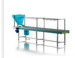
نوار نقاله دستچین جهت پاکسازی حبوبات و یا چک نهایی محصولات می باشد. این دستگاه مجهز به تسمه نقاله از جنس PVC و سیستم کنترل سرعت نوار، سیستم کنترل ریزش محصول است. دستگاه دستچین داری نور مهتابی جهت دید بهتر و محل جداسازی ضایعات می باشد.
