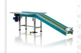
دستگاه نوار نقاله جهت انتقال بسته های تولیدی از جلوی دستگاه بسته بندی جهت جمع آوری نهایی می باشد. نوار نقاله بارگیری مجهز به تسمه نقاله از جنس P.V.C در دو مدل گریپ و پله دار است. این دستگاه مجهز به میز استیل در کناره ها جهت قرار دادن محصولات می باشد. همچنین سرعت حرکت نوار متناسب با سرعت دستگاه بسته بندی قابل تنظیم است.
