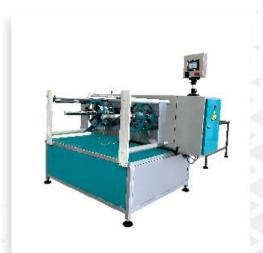
جهت باز کردن و بستن مجدد رول سلفون با قابلیت نصب دستگاه جت پرینتراست. استفاده از دستگاه رول به رول در مقایسه با استفاده از چندین دستگاه تاریخ زن بسیار مقرون بصرفه تراست. بسیاری از مجموعه های تولید و بسته بندی مواد غذایی، بیش از یک دستگاه رول به رول در این کارخانه ها به جای چندین برینتر بهینه تراست.
