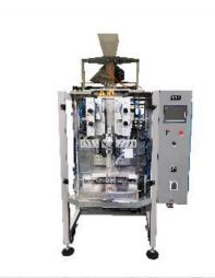
پکینگ دستگاه بسته بندی عمل فرم دهی به سلفون و پر کردن و دوخت نهایی بسته را به عهده دارد. دستگاه های پکینگ کاوش صنعت به دو مدل ساده (بسته بندی بالشتی) و پنج طرف دوخت تقسیم می شود. تفاوت پکینگ پنج طرف دوخت نسبت به مدل معمولی پکینگ کاوش صنعت قابلیت بسته بندی در چهار فرم می باشد.
