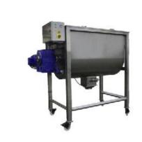
جهت مخلوط کردن چند پودر با ساختاری شبیه به هم و با سرعت بالا می باشد. دستگاه میکسر قابل استفاده در مصارف خانگی و صنعتی است.
