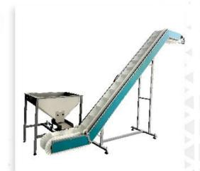
دستگاه بالابر مدولار مخصوص انتقال مواد گرانولی به مخزن دستگاه بسته بندی است. بالابر مدولار دارای نوار مدولار از جنس پلاستیک، مخزن ویبره از جنس استنلس استیل و قیف خروجی می باشد. جنس بدنه دستگاه بالابر از آهن است که با رنگ کوره ای الکترواستاتیک کاور شده است. مخزن بالابر مدولار از جنس استیل است.
